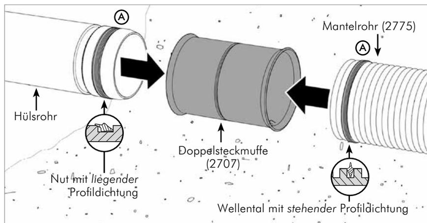
Die Profildichtungen (A) stehen in das 2. Wellental des Mantelrohrs und in die Nut des Hülsrohres liegend platzieren. Danach beide Profildichtungen fetten (Gleitmittel DOYMA 2780 verwenden) und das Mantelrohr (2775) in die Doppelsteckmuffe bis zum Anschlag einschieben. Danach die Doppelsteckmuffe zusammen mit dem Mantelrohr auf das Hülsrohr schieben.
