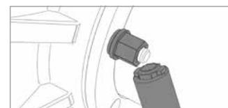
Solange fortfahren bis sich die oberen Muttern abdrehen (ITL-Prinzip: Integrated Torque Limiter; kein Spezial-Werkzeug nötig).
