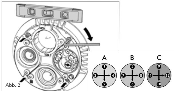
Ankerplatte bündig an die Wand schieben und ausrichten. Die Ausrichtung der Ankerplatte und Anordnung der einzelnen Gewerke ist variabel möglich, sollte aber mit dem zuständigen Netzbetreiber abgestimmt werden! Die vier Innensechskantschrauben – Reihenfolge beachten (1,2,3,...)! Anziehen in mehreren Intervallen (A, B, C)! Die Schrauben soweit anziehen bis der Anschlag merklich fühlbar ist.
