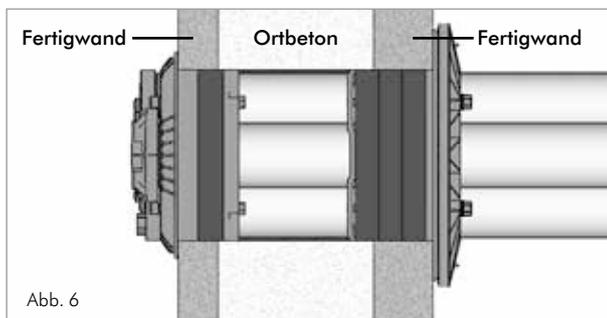
Bei Doppel-/Elementwänden schieben Sie die Außenabdichtung Quadro-Secura® Nova 1/breit über die Hülrohr der Mehrsparte in die Kernbohrung, bis die Lamellendichtung auf der Wandoberfläche (Weiße Wanne; WU-Betonkernbohrung) bzw. an der Hautdichtung (Schwarze Wanne) umlaufend anliegt.
