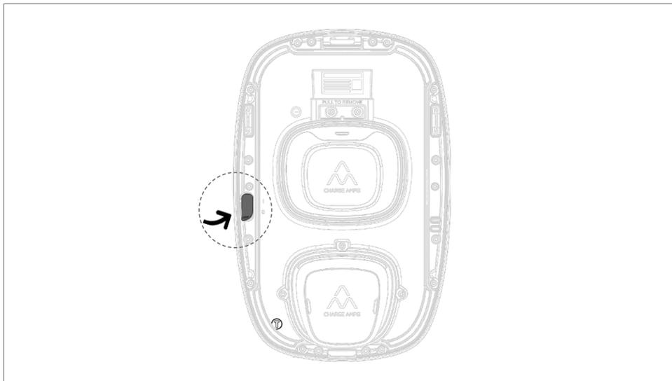
6. Montieren Sie die Charge Amps Dawn wieder, indem Sie den Bodenflansch der Frontabdeckung einsetzen und die Abdeckung an die richtige Position drehen. Sichern Sie die Abdeckung anschließend mit der Sicherungsschraube (Torx 25).
