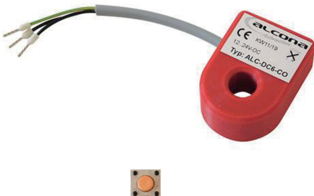
Der im STROMAT integrierte DC-Wächter besitzt einen Test-Knopf zur Überprüfung der Fehlerstromschutzeinrichtung. Bei Betätigen wird ein 6 mA DC-Fehlerstrom generiert. Daraufhin erzeugt der DC-Wächter einen AC-Fehlerstrom, welcher den in der Hausverteilung vorhandenen Fehlerstromschutzschalter auslöst.
