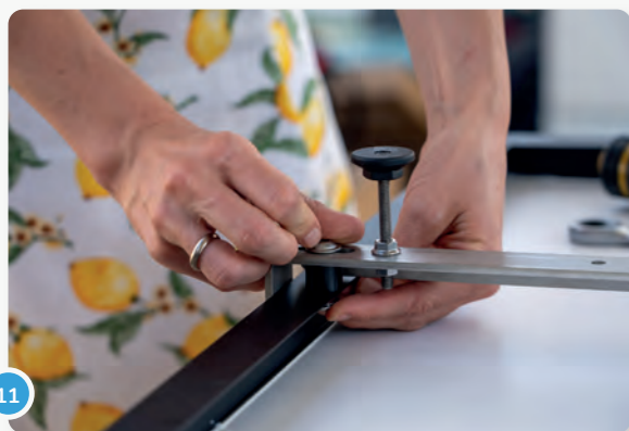
11 Das Ganze wiederholst du nun auch noch auf der Unterseite der Haken. Distanzhülse und Schraube positionieren...
