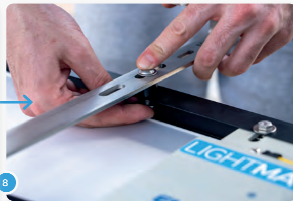
8 ...und führe die passende Schraube durch Loch und Distanzhülse hindurch.
